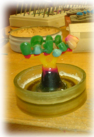
Armature en cire sur arbre de coulée
